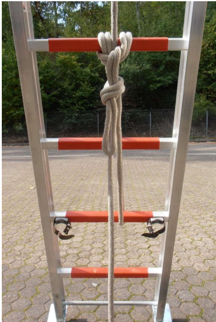
Abbildung 24: Sichern des Zugseils mit Mastwurf und Spierenstich
