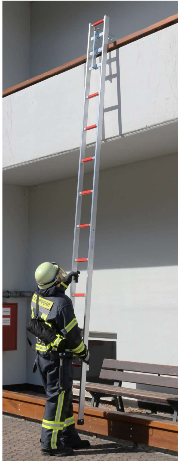
Abbildung 27: Einhängen der Hakenleiter
