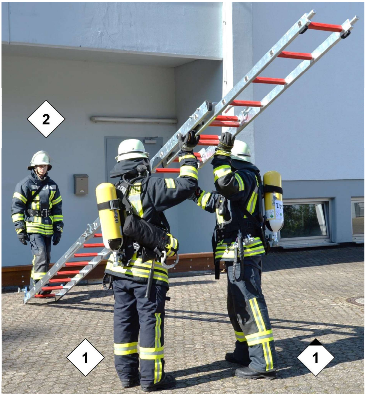
Abbildung 36: Aufrichten der Multifunktionsleiter
