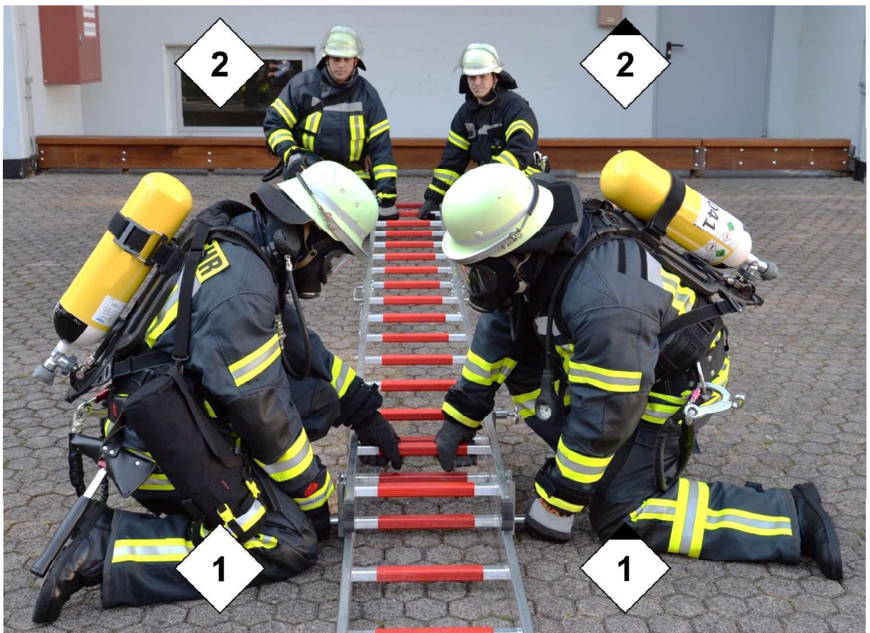
Abbildung 41: Verbinden der Multifunktionsleitern
