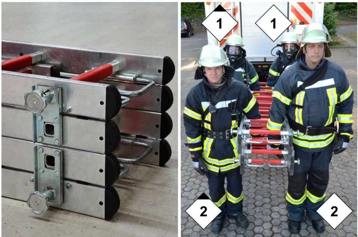
Abbildung 37: Trageweise der Multifunktionsleitern zur Anleiterstelle
