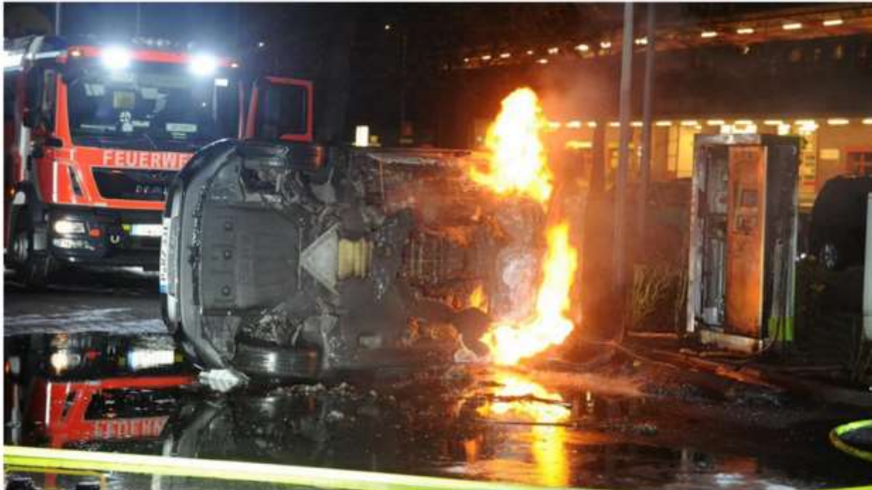
Die Feuerwehr musste den Mini auf die Seite kippen, um an die brennende Batterie zu kommen.
